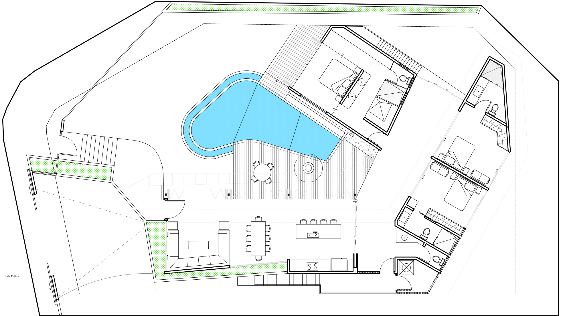
PLANTA DE DISTRIBUCION ARQUITECTONICA SEGUNDO NIVEL ESC: 1:50
